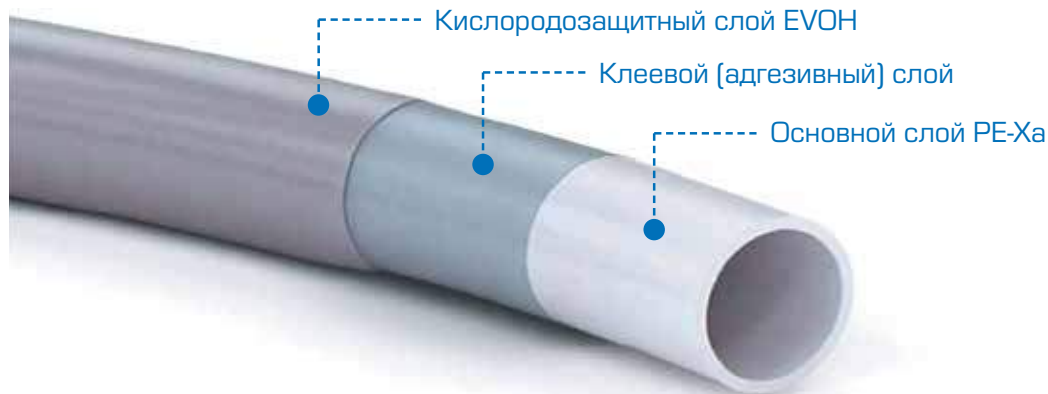
Рис. 2.1. Трехслойная труба РЕ-Ха/EVONH
