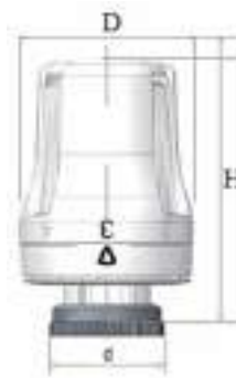
Рис. 7.6. Габаритные и присоединительные размеры термоголовки Арт. SHT 0002 003015
