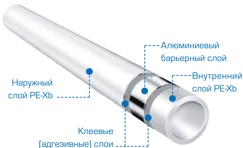
Рис. 2.2. Пятислойная металлополимерная труба PE-Xb/AL/PE-Xb
