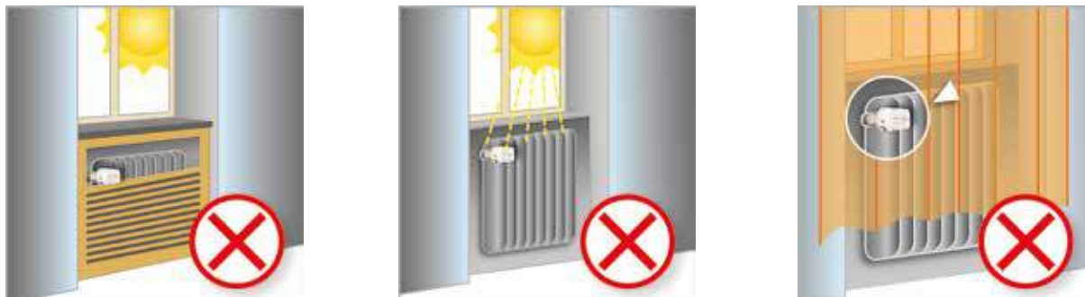
Рис. 7.10. Требования по размещению автоматического терморегулятора
